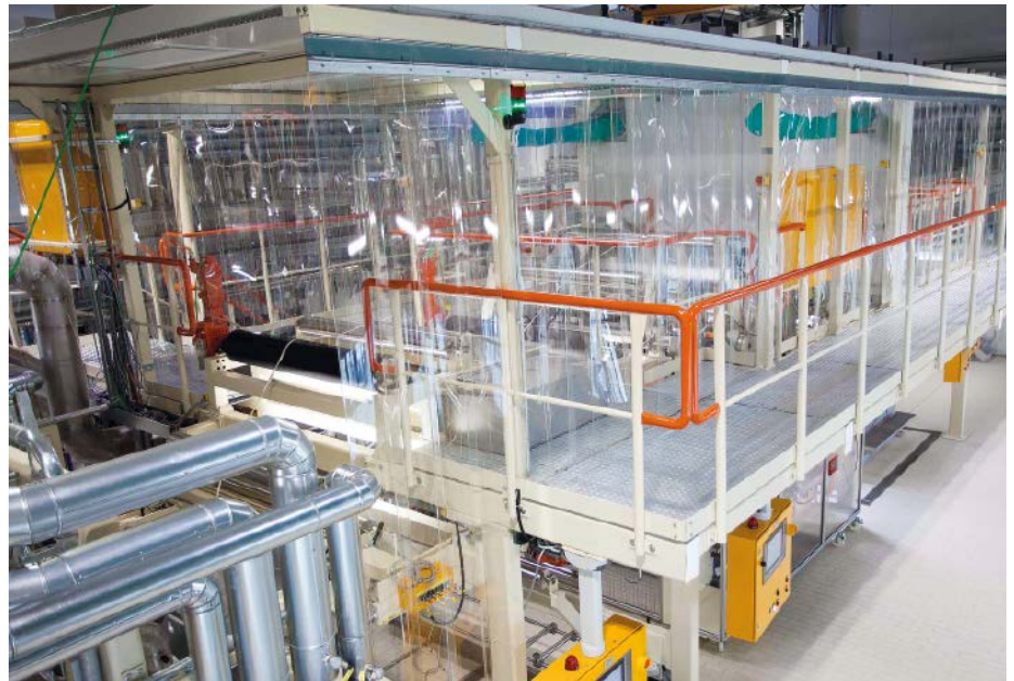
Abb. 2: Echtzeitsensorik für Hightech-Folienproduktion: Am Standort in Troisdorf stellt Kuraray hochwertige PVB-Folien her, die als Zwischenlagen in anspruchsvollen Sicherheitsverglasungen in Architektur und Automotive zum Einsatz kommen. Gemeinsam mit den Forschern des Fraunhofer-Instituts testet Kuraray, wie neue 5G-Sensorik zu einer höheren Qualität sowie weniger Abfällen, Emissionen und Energieverbrauch beitragen kann.
